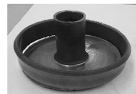
図13 外側カップ角部の割れ
