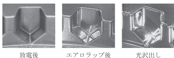
図14 ギアダイスのラップ工程
