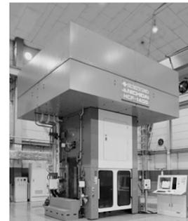
図6 油圧式複動プレス（弊社所有）
