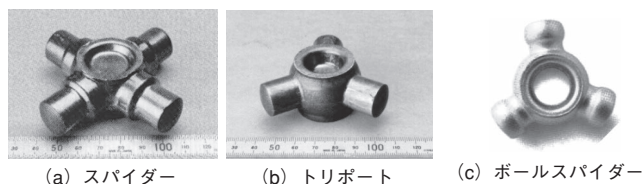
図1 閉塞鍛造により成形された鍛造品
