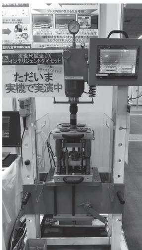
荷重センサや変位センサ、AEセンサなどを組み込み（最大16チャンネル）、プレス機からの実荷重や金型の変位などを、1ショットごとやりアルタイムでモニタリングすることでプレス内部の状態を把握し、製品や金型異常の早期発見につなげ、最適な金型メンテナンスや製品不良の削減を図る。伊藤直紀社長は「インテリジェントダイ
