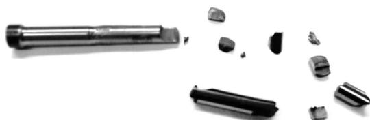
図2 座屈によって破損したパンチ
