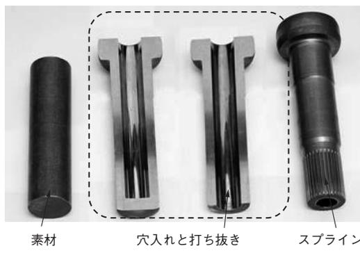
図11 補助張力押し出しの実用サンプル
